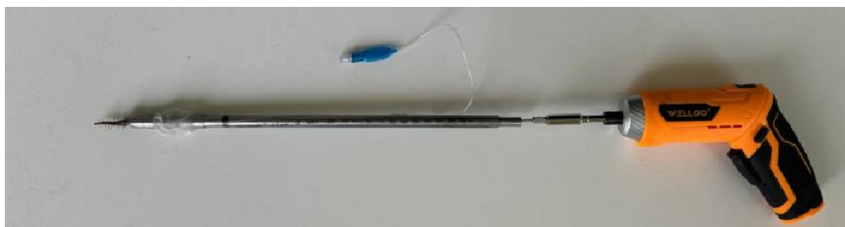
Рис. 5. Внешний вид устройства для обработки остаточных полостей. Функцию футляра устройства выполняет усовершенствованная пункционная игла
