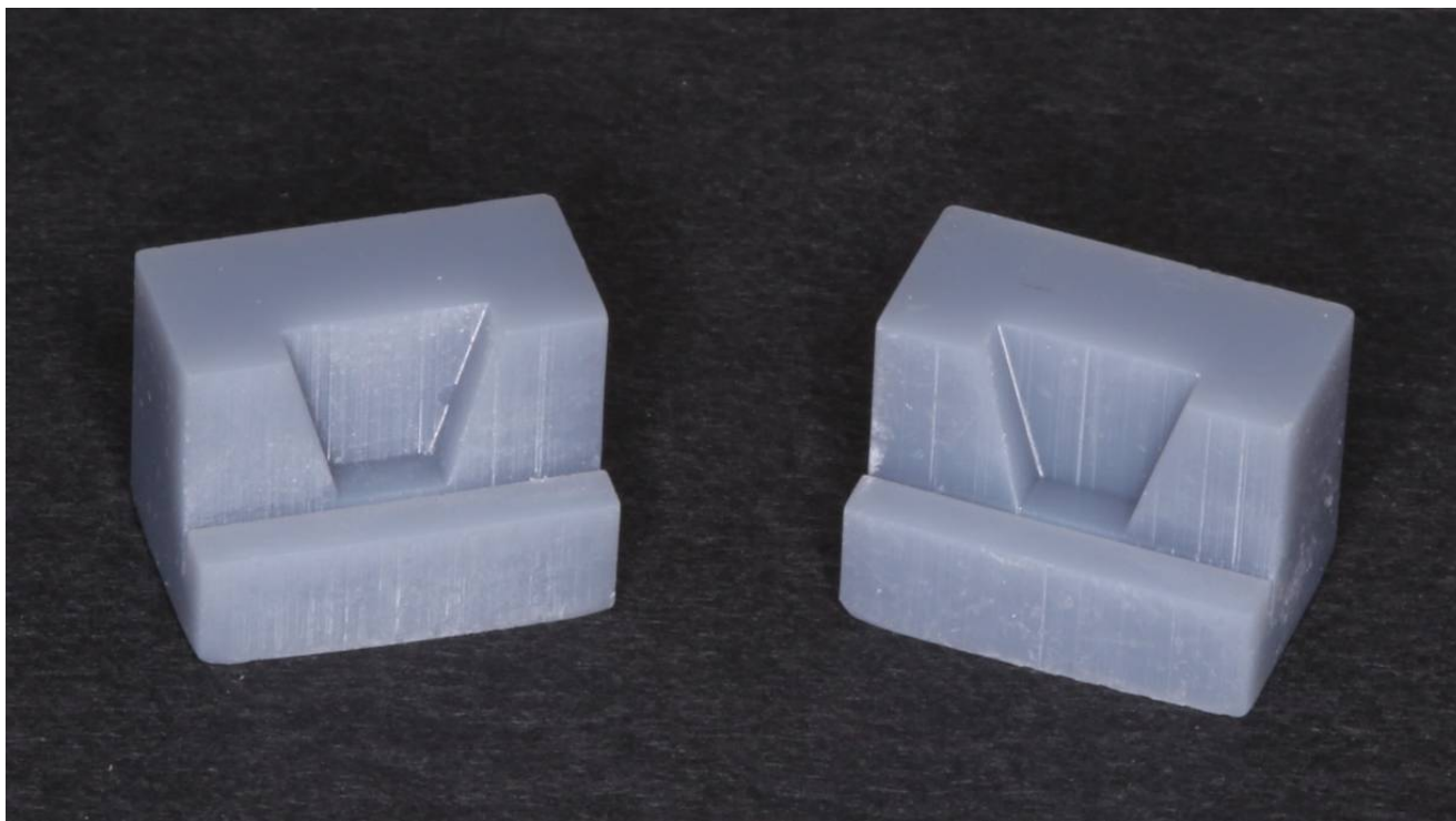
Рис.1. Пластиковые формы с трапециевидными слотами для композитного материала
