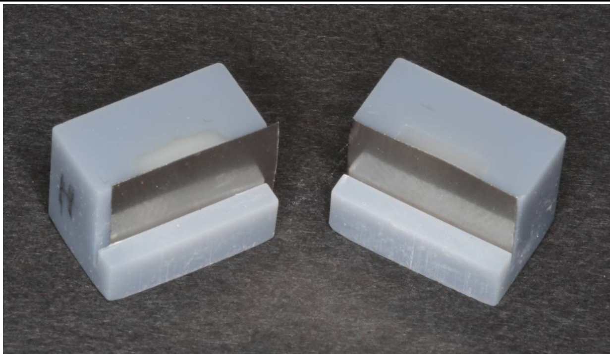
Рис.2. Пластиковые формы с трапецевидными слотами, покрытыми ленточной металлической матрицей и заполненными композитным материалом
