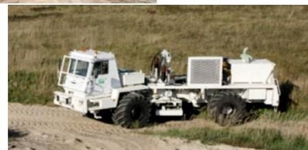
**Рис. 1. Вибрационные машины, используемые при проведении полевых сейсмических работ**
